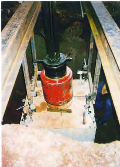
Posicionamento do macaco hidráulico e defletômetros para prova de carga estática. Resultado mostra o recalque em função da curva de carga sob carregamentos constantes
