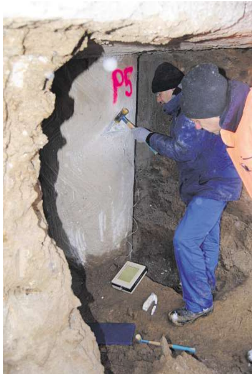
Dreimal klopft Mayer mit dem Gummihammer gegen den Pfahl.
