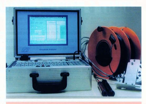
تقدم "بايل داينمكس" أحدث أجهزة التأكد من الجودة، وهو "Cross-Hole Analyzer" القادر على فحص الأساسات الرأسية باستخدام مبدأ التسجيل الصوتي.
