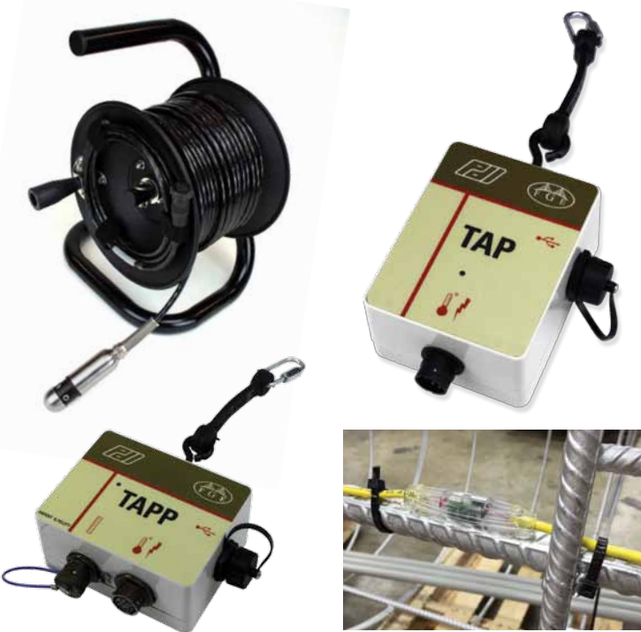
Hình ảnh thiết bị (theo chiều kim đồng hồ từ dưới bên trái) : Bộ thu thập cho đầu đo nhiệt (TAPP), Đầu đo nhiệt kèm dây, Bộ thu thập cho dây nhiệt (TAP) và sensor đo nhiệt độ kiểu số
