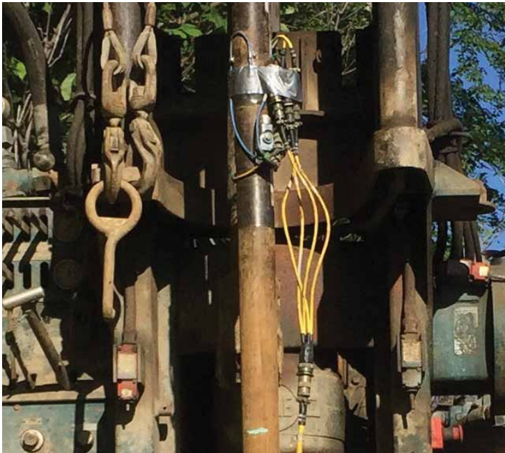
Martillo SPT siendo calibrado con el Analizador de SPT. Observe la instrumentación en la vara.
