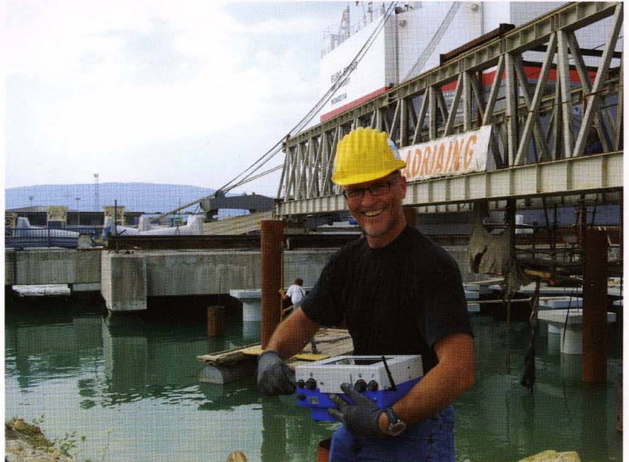
Los sensores inalámbricos son especialmente útiles para realizar pruebas en pilares de soporte en muelles y puertos.
