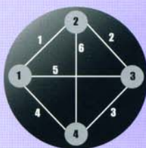
Sección transversal del fuste con cuatro tubos; seis caminos son probados.
