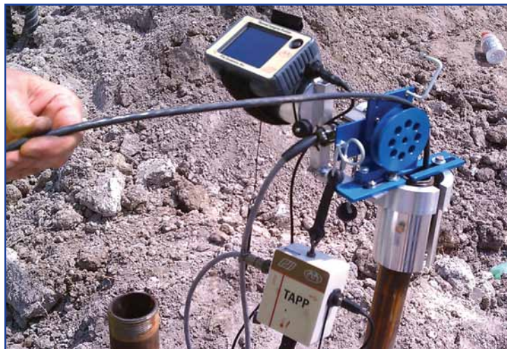
Thermal Integrity Profiler (погружной датчик)
