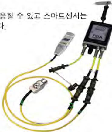
오른쪽 상단에서 시계방향으로 무선 송신기, 가속도계 및 변형률계
