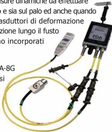
In senso orario in alto a destra: Trasmettitore Wireless, Accelerometro e Trasduttore di Deformazione
