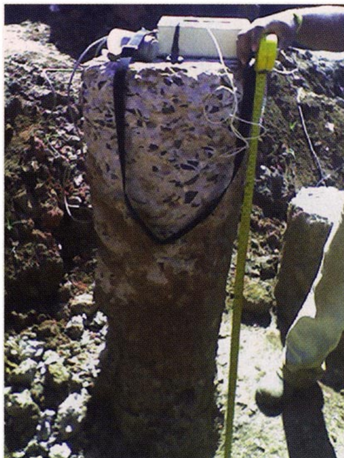
Las fotos muestran un pilote de 37 cm de diámetro, cuyo ensayo reveló una anomalía significativa a 1.2 m de profundidad
