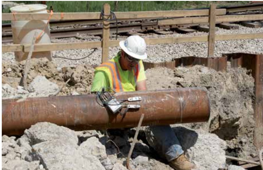
Um dos fatores que influencia a qualidade dos ensaios de carregamento dinâmico são os sensores – devem estar bem acoplados calibrados, e em bom estado
