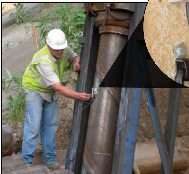
O PDA também avalia a energia dos martelos de SPT através de medições de força e velocidade.
