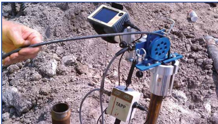
Thermal Integrity Profiler TIP - Sistema con Sonde.
