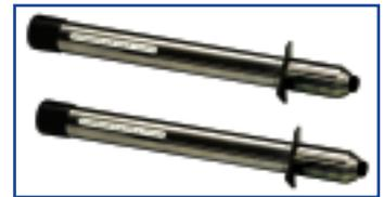
Sonda trasmittente e ricevente completi di pesi.
