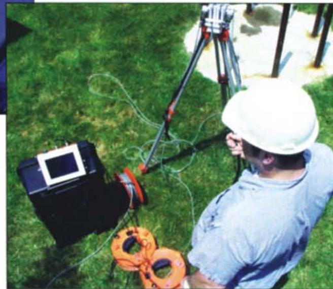
CHA-QX 和CHAMP 都支持双向高分辨率深度编码器来单独测量探头实时所在深度及其移动方向。不论探头向上移动还是向下移动，CHA 都可以进行数据采集。深度编码器可以直接放到声测管上，此时精度最高；也可以放到三角架上，便于现场操作。
